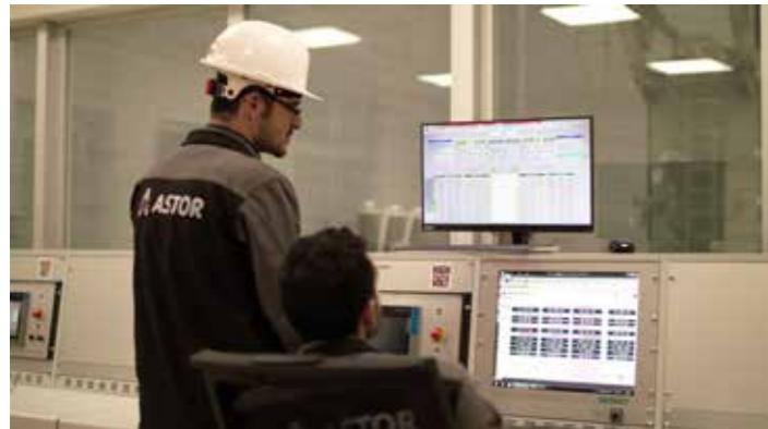
Yalıtımın Güç Faktörü Ölçümü Deneyi
